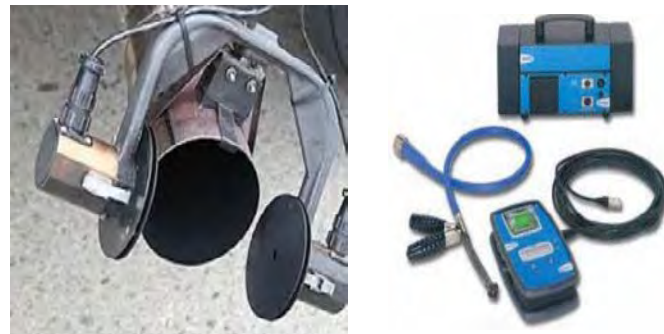
Abb. 28: Opazimetermessung am Abgasendrohr
