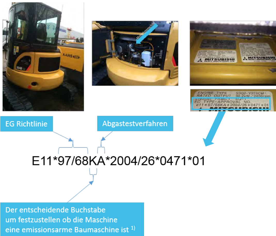
Abb. 5 : Erkennung des Emissionsstandards an Motoren
