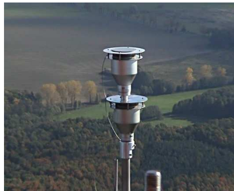
Abbildung 2.7: Probenahme in 325 m Höhe durch Whitby-Köpfe
