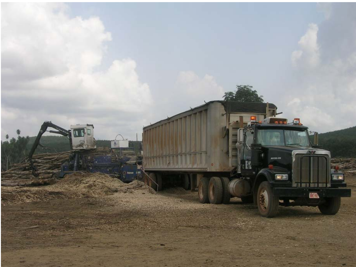
Bild 1 Vor-Ort Verarbeitung von Bäumen zu Hackschnitzeln und Verladung
