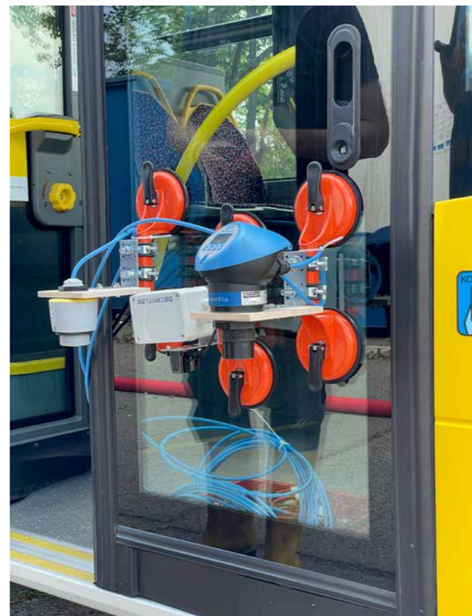
Test der Funksensoren am BVG-Bus
