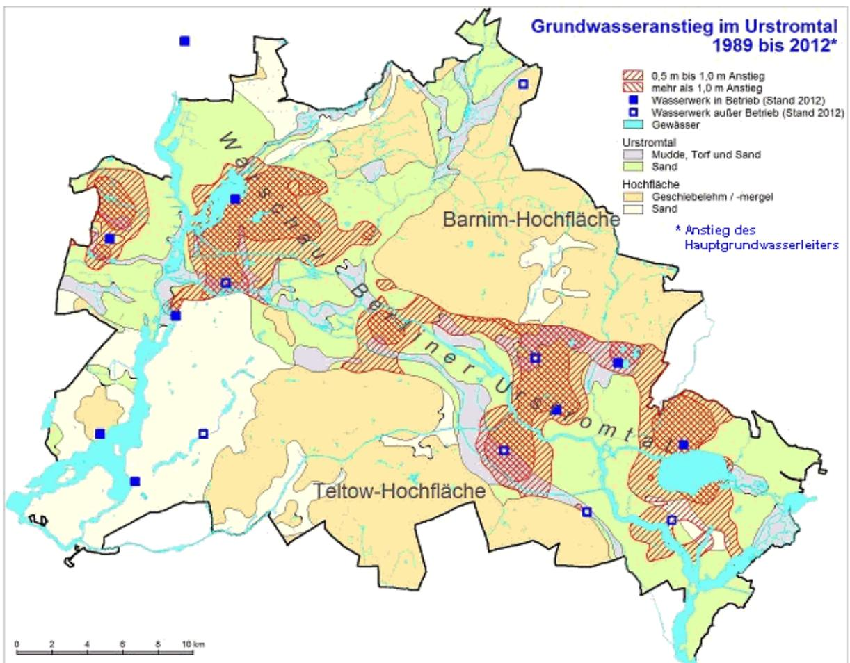
Abb. 10: Grundwasseranstieg von 1989 bis 2012 im Urstromtal
