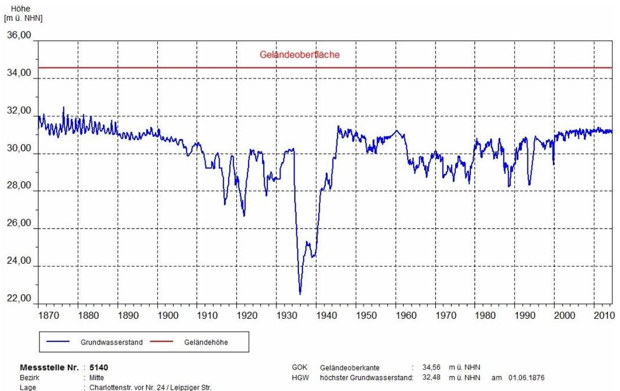
*Abb. 9: Grundwasserstandsganglinie einer Messstelle aus der Innenstadt seit 1870. Der höchste Grundwasserstand (HWG) wurde hier am 1.6.1876 gemessen. Der Grundwasserstand ist durch zahlreiche Grundwasserabsenkungen seit 1905 zeitweise stark beeinflusst.*
