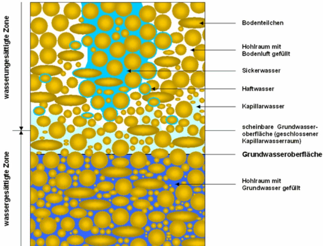
Abb. 2: Erscheinungsform des unterirdischen Wassers (aus Hölting 1996)
