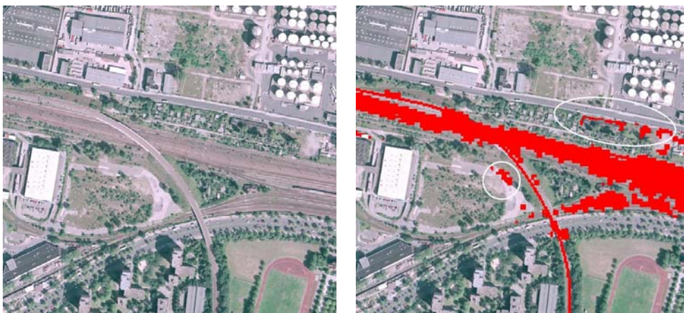
Abbildung 12: Abgrenzung von Gleisschotter – Ausschnittvergrößerung
