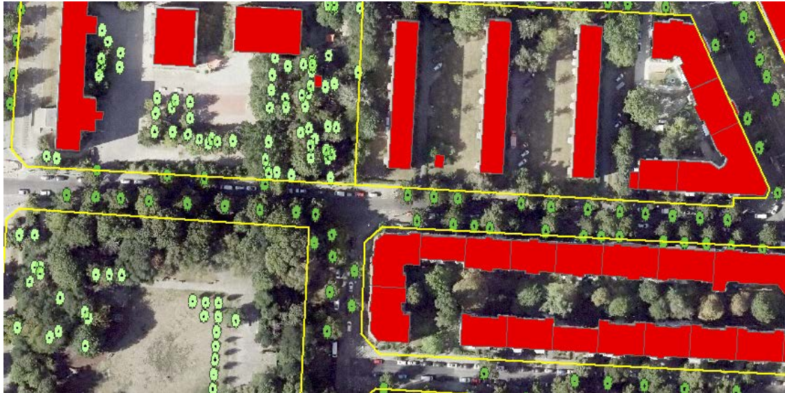
Abb. 2: Ausschnitt aus den verwendeten Geobasis- und -fachdaten: ALKIS-Gebäudelayer (rot), ISU5-Block(teil)grenzen (gelb), Straßenbaum-Objekte (dunkelgrün), Anlagenbaum-Objekte (hellgrün) vor dem Hintergrund der True-Orthophotos 2020 (Quelle: SenStadtWohn - Geoportal Berlin)
