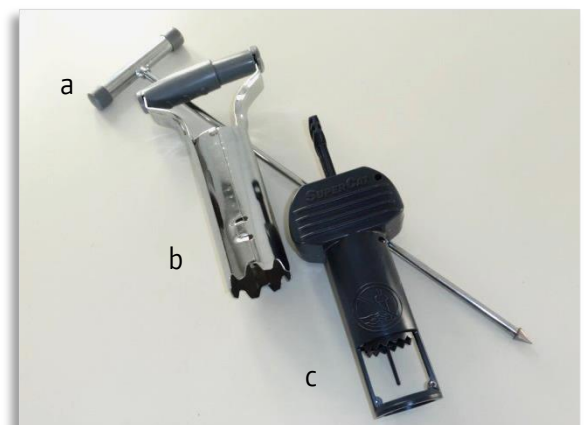
Abb. 7: SuperCat® Falle (Set) a) Stabsonde, b) Lochstecher, c) Falle
