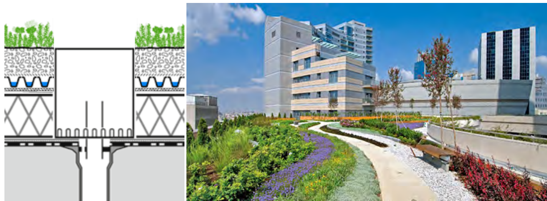
Links: Beispielschnitt Drossel (ZINCO); Rechts: Beispiel Gründach (Fa. ZINCO)
