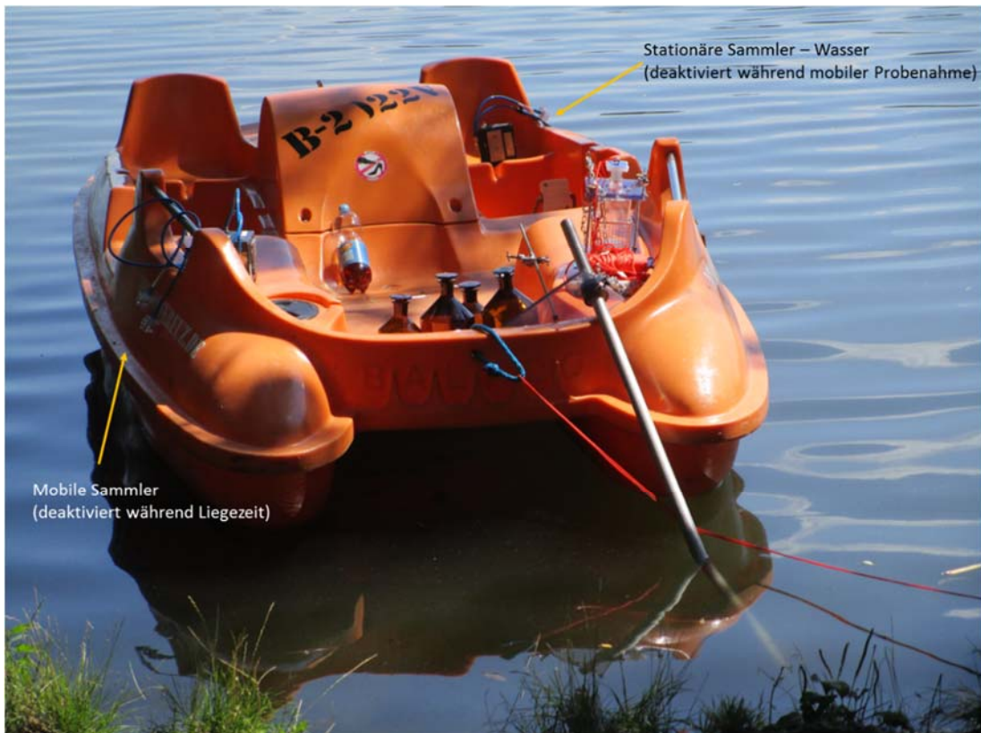
Abbildung 20: Positionierung der stationären Sammler auf dem Wasser und der Sammler für die mobile Probenahme (Boot).
