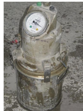
Abbildung 5-5: Bestimmung des Luftporengehaltes [Mettke, 04.11.2013]
