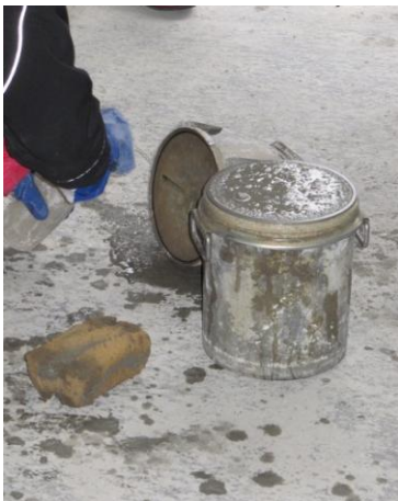
Abbildung 5-4: RC-Beton im Luftporentopf in Vorbereitung der Bestimmung des Luftporengehaltes [Mettke, 04.11.2013]
