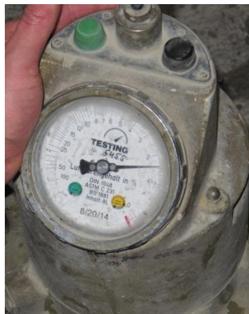
Abbildung 5-5: Bestimmung des Luftporengehaltes [Mettke, 04.11.2013]
