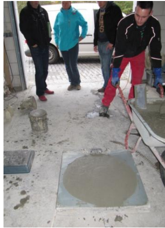
Abbildung 5-3: links: Bestimmung des Ausbreitmaßes im Betonwerk [Mettke, 04.11.2013] und rechts: Bestimmung des Ausbreitmaßes auf der Baustelle [Schmidt, 22.11.2013]
