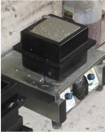
Abbildung 5-2: Herstellung eines Betonprüfkörpers zur Bestimmung der Frisch- und Festbetonrohichte sowie der Druckfestigkeit [Mettke, 04.11.2013]
