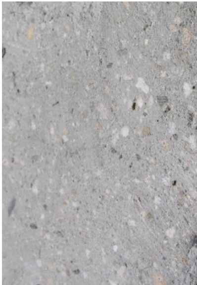
Abbildung 6-2: Schnitt durch RC-Beton-Prüfkörper [Jacob, 17.11.2014]
