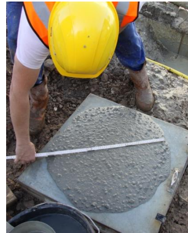
Abbildung 5-3: links: Bestimmung des Ausbreitmaßes im Betonwerk [Mettke, 04.11.2013] und rechts: Bestimmung des Ausbreitmaßes auf der Baustelle [Schmidt, 22.11.2013]
