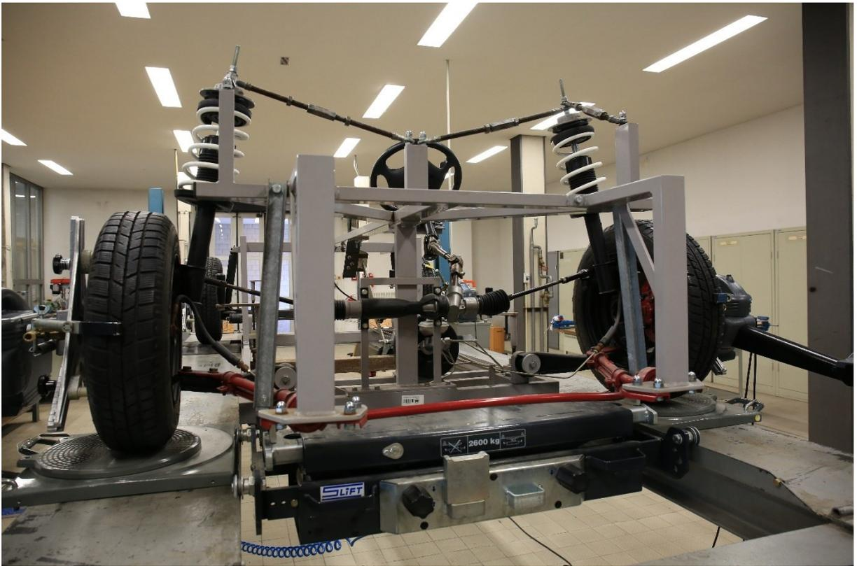
Modellkomponenten eines Pkw zur Veranschaulichung des Steuermechanismus, Foto: Lisa Vanovitch
