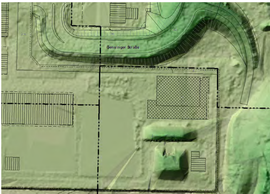
Abb.17: Digitales Geländemodell Bereich Gensinger Straße., gut erkennbare der Druckschutzwall bei Haus 11
