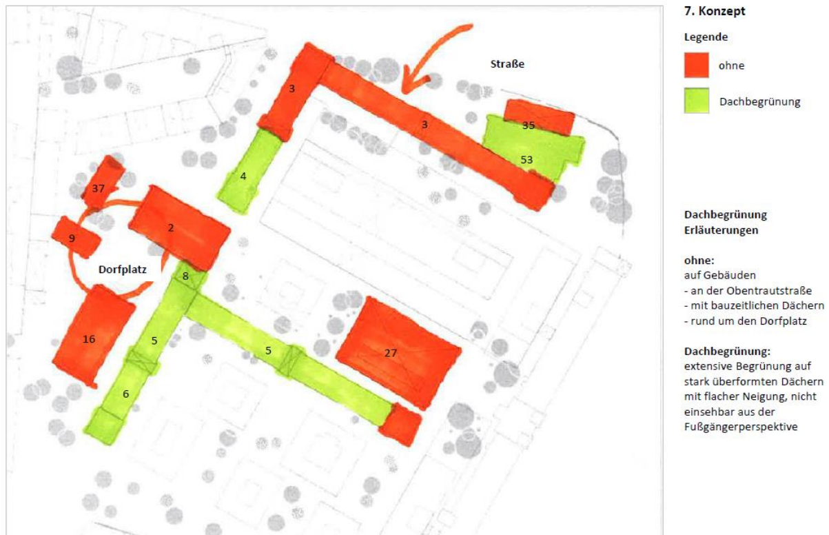
Abbildung 15: Untersuchung Dachbegrünung denkmalgeschützte Gebäude Quelle: büro west denkmalpflege. Dragonerareal Gutachten Dachbegrünung. 2022.
