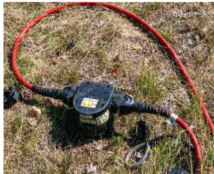
Abbildung 1 bis 3: Rootwave-Pro-System (links); Bezugs Elektrode mit 20 Meter Behandlungskabel (mittig); Applikation mit der Handlanze an Vogelknöterich in Gehwegfugen (rechts).
