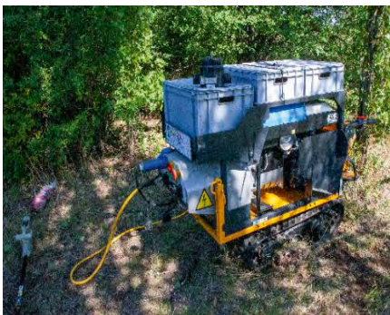
Abbildung 1 bis 3: Rootwave-Pro-System (links); Bezugs Elektrode mit 20 Meter Behandlungskabel (mittig); Applikation mit der Handlanze an Vogelknöterich in Gehwegfugen (rechts).
