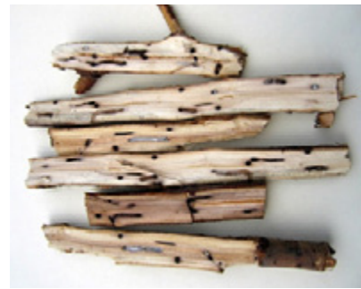
Befall mit Ungleichem Holzbohrer
