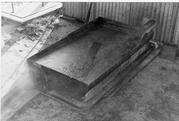
Hier kristallisiert der Sprengstoff und wird täglich der Vernichtung durch Verbrennen zugeführt.
