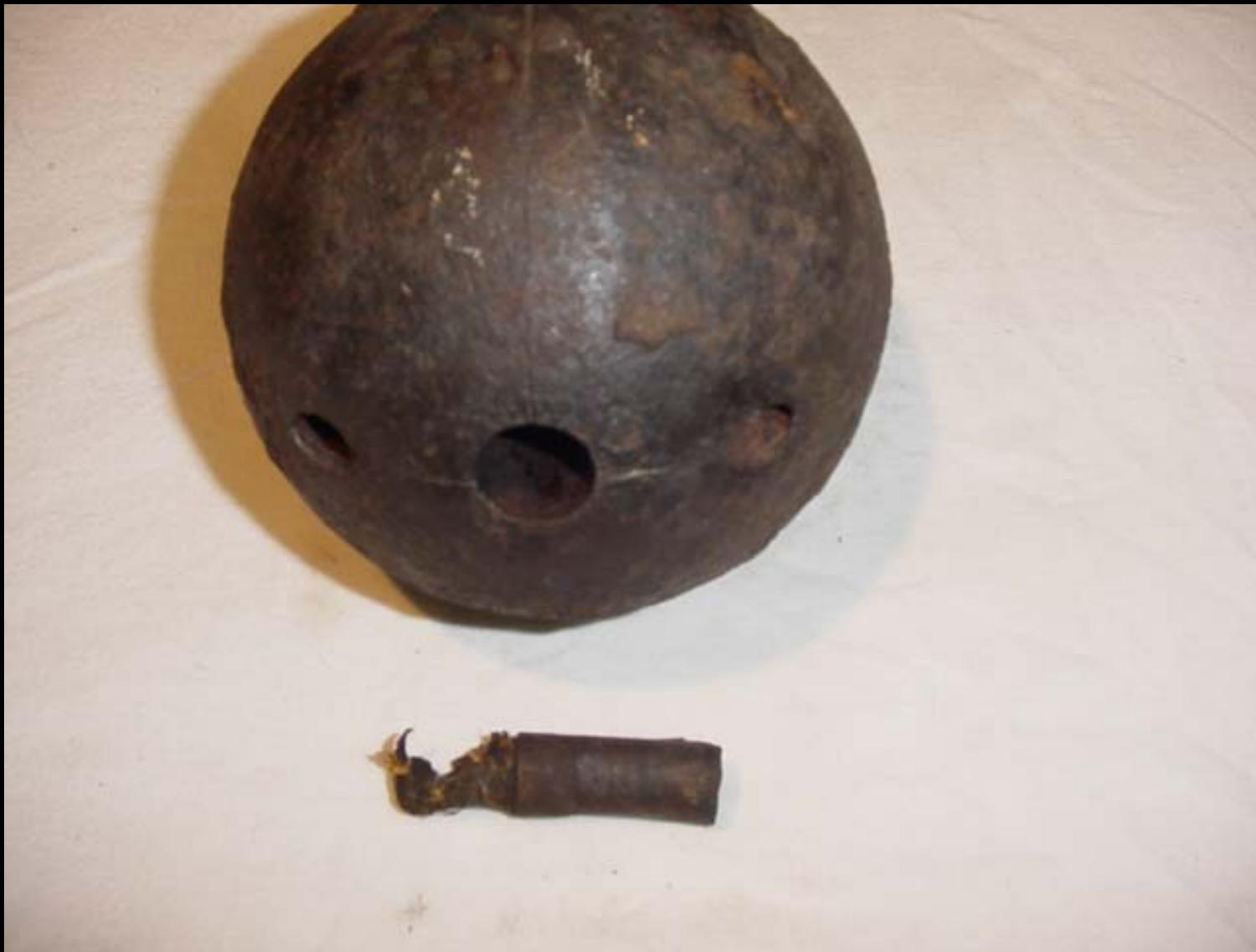
Kanonenkugel ca. 1825, Brandröhre mit Papierhülse, Fertigung in Spandau, D=ca. 11,5cm; Leergewicht = 4,12 Kg
