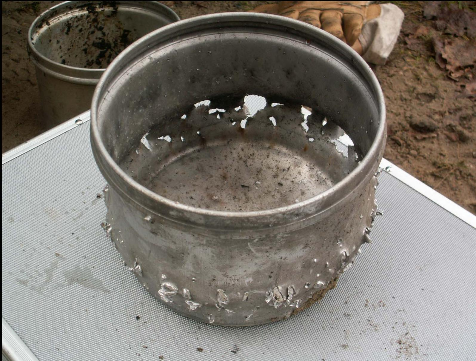
Wirkversuch mit einem Sprenggeschoss, Kaliber 13mm,
