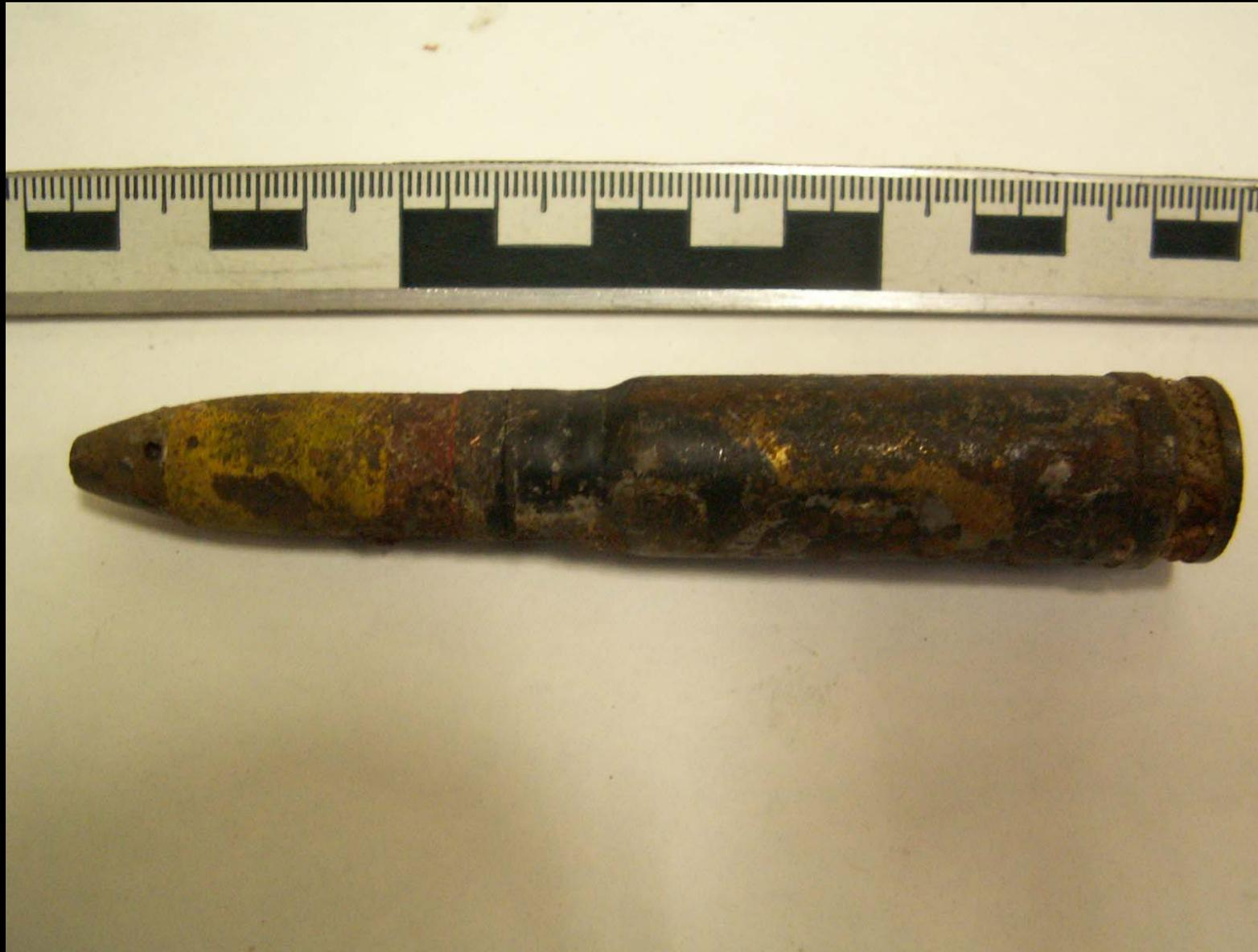
Wirkversuch mit einem Sprenggeschoss, Kaliber 13mm,
