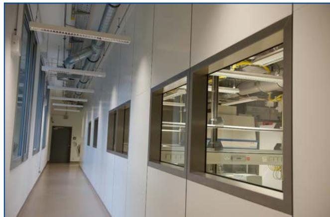
Das technisch dichte Hochsicherheitslabor ist ein von der Umgebung völlig getrennter aerosol- und luftdichter Raum mit eigener Luft-, Strom- und Wasserversorgung. Bei einer Laborfläche von ca. 330 qm können bis zu 10 Personen gleichzeitig arbeiten. (Quelle: Hans-Günter Bredow / RKI)
