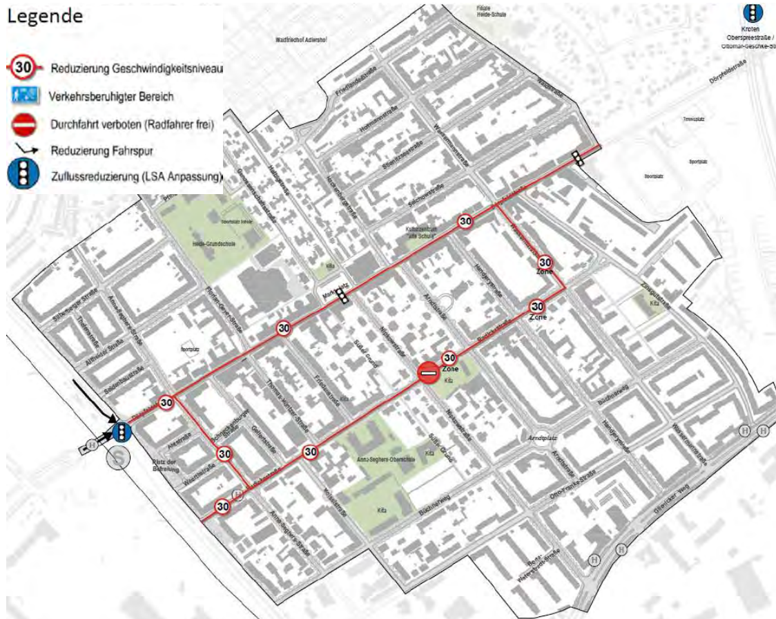
Abb. 41: Gesamtheit der empfohlenen Kfz-verkehrsbezogenen regulatorischen Maßnahmen
