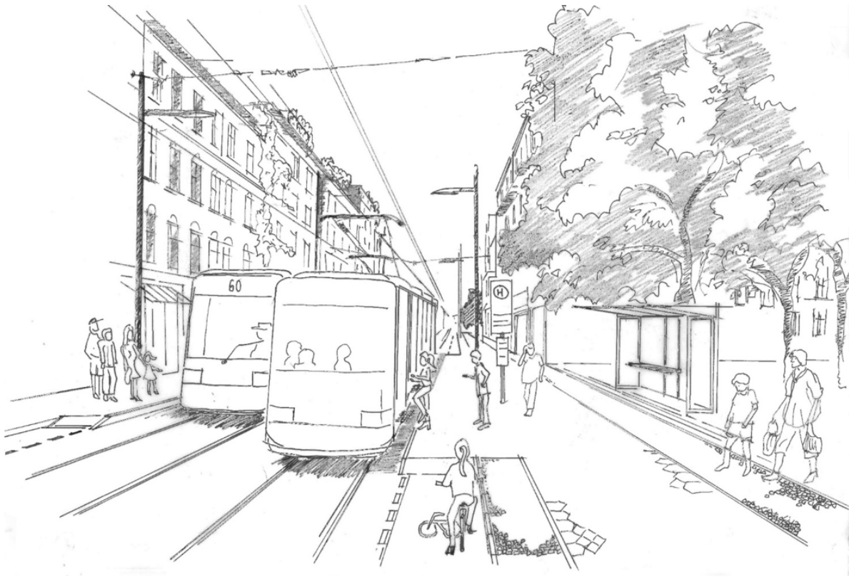
Abb. 16: Barrierefreie Kaphaltestelle mit Hochbord und überführendem Radweg
