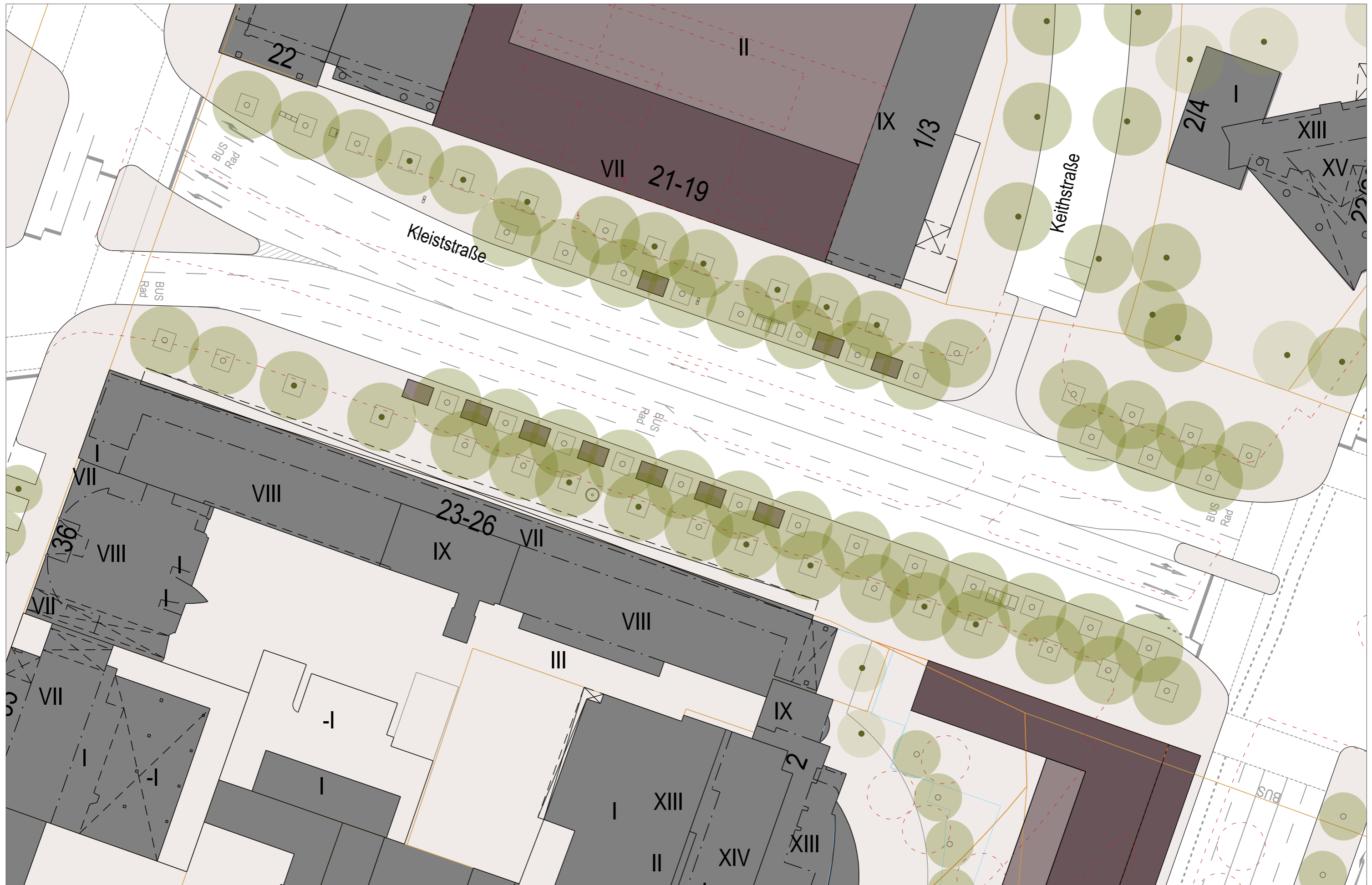
City West - Qualifizierung der östlichen Eingangsbereiche - Weiterbearbeitung Konzept Kleiststraße 1.1 - Verbreiterung der Seitenräume, Verzicht auf Mittelstreifen - Lageplan (mit Umbau des Knotens)
