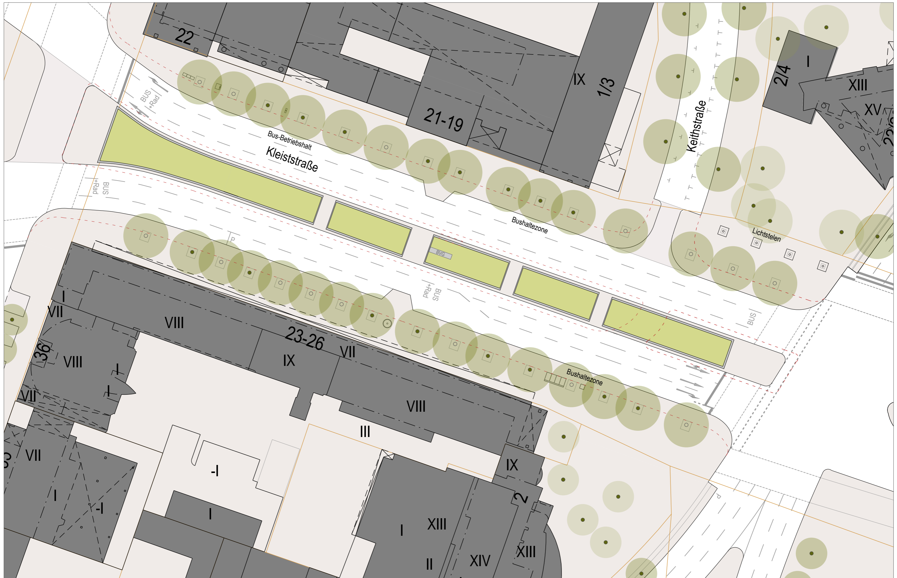
City West - Qualifizierung der östlichen Eingangsbereiche - Weiterbearbeitung Konzept Kleiststraße 3.1.2 - Verbreiterung der Seitenräume, reduzierter Mittelstreifenquerschnitt - Kombistreifen Bus / Rad - ohne Bäume - Lageplan (ohne Umbau des Knotens)
