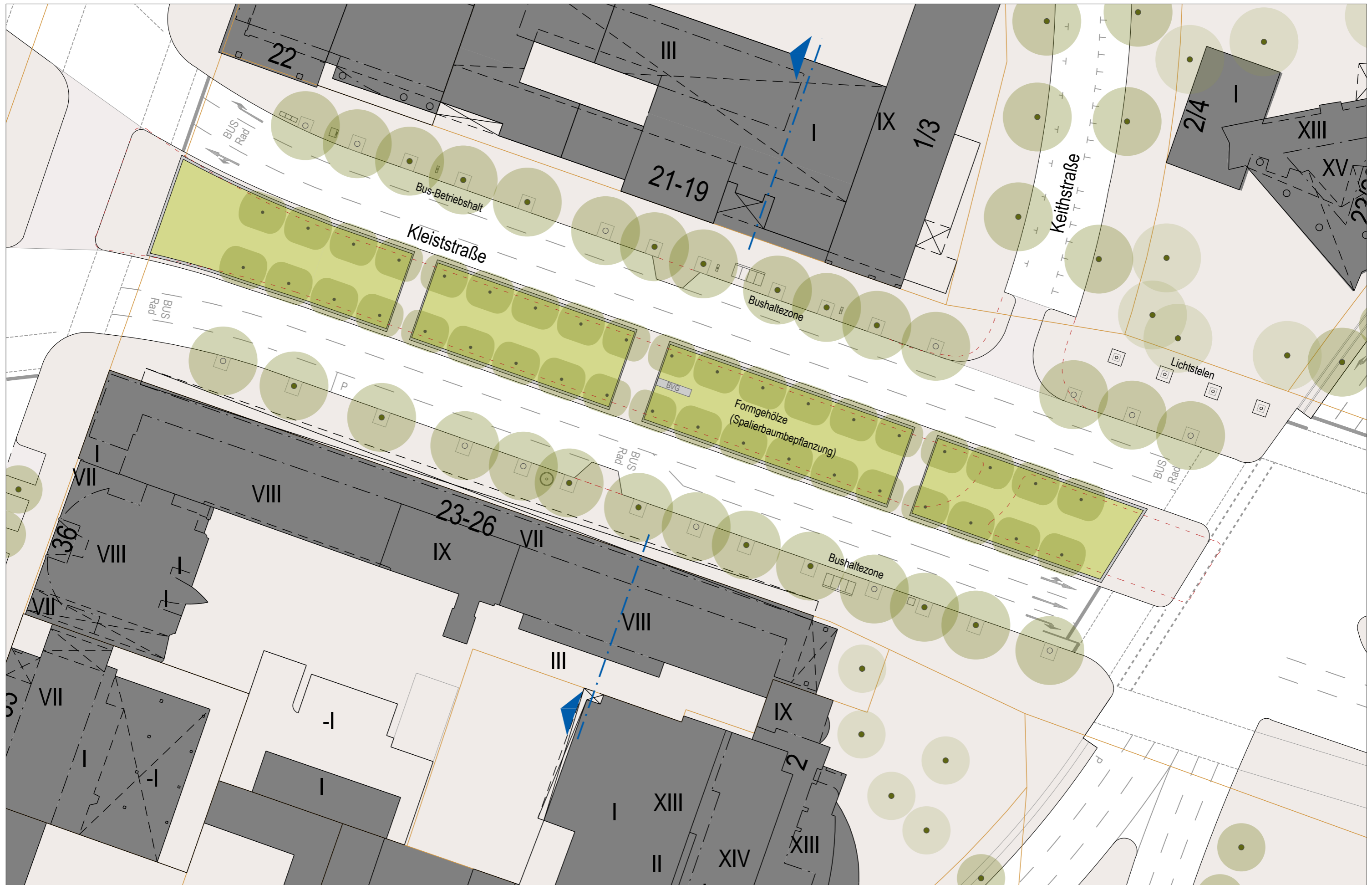
City West - Qualifizierung der östlichen Eingangsbereiche - Weiterbearbeitung Konzept Kleiststraße Variante 2.1.4 - Verbreiterung des Mittelstreifens, Erhalt der Seitenraum-Bordlinie - Kombistreifen - mit Bäumen - Lageplan (ohne Umbau des Knotens)
