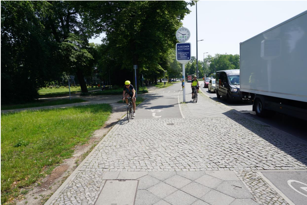
Foto 4: Ein Teil der Radfahrenden fährt nach Ende der Ausbaustrecke geradeaus, weil die Wegeführung nicht intuitiv erfassbar ist bzw. weil sie den Stop vor der roten Fußgängerampel am weiterführenden alten Bordsteinradweg in Richtung Norden (Neuendorfer Straße) bzw. Osten (Schönwalder Straße) vermeiden. (Quelle: Willi Loose)
