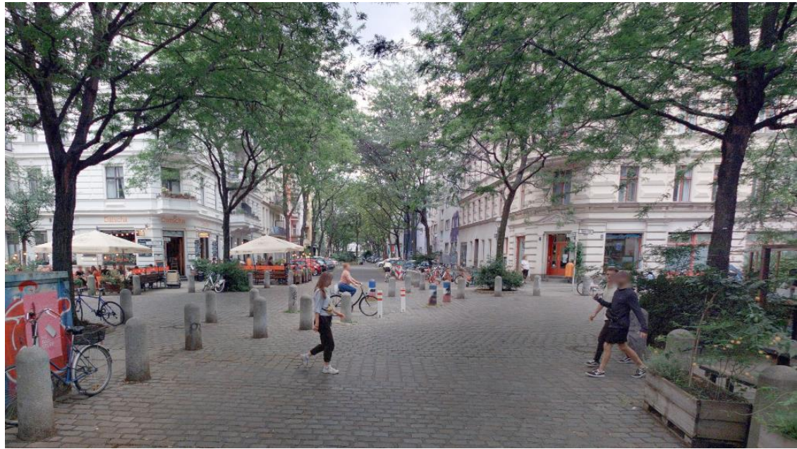
Abbildung 5: Flächige Diagonalsperre Böckhstr. mit sicherer Diagonalquerung für Fußverkehr in einem verkehrsberuhigten Bereich
