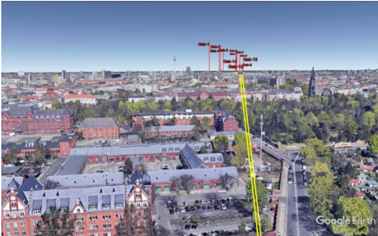
Abbildung 17: Darstellung der berücksichtigten Gebäude bzw. Geländeerhebung aus der Perspektive des Radarortungsgerätes
