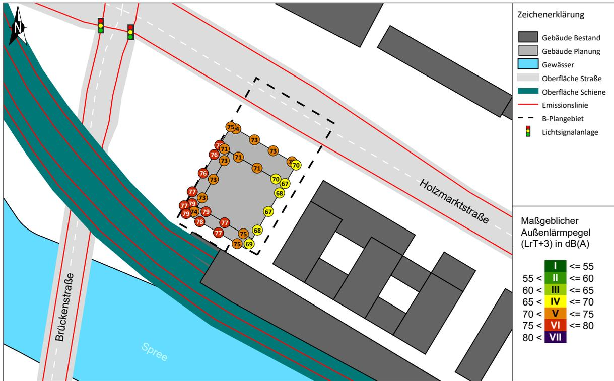
Abbildung 11 Gebäudelärmkarte für das lauteste SW, maßgeblicher Außenlärmpegel (Büro), 06:00 - 22:00 Uhr
