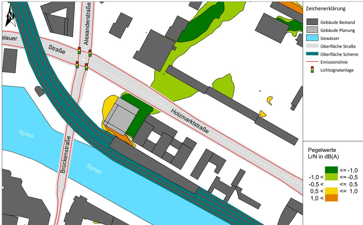
Abbildung 16 Isophonenkarte in 15 m Höhe über Gelände, Differenz Nullfall - Planfall, 22:00 - 06:00 Uhr
