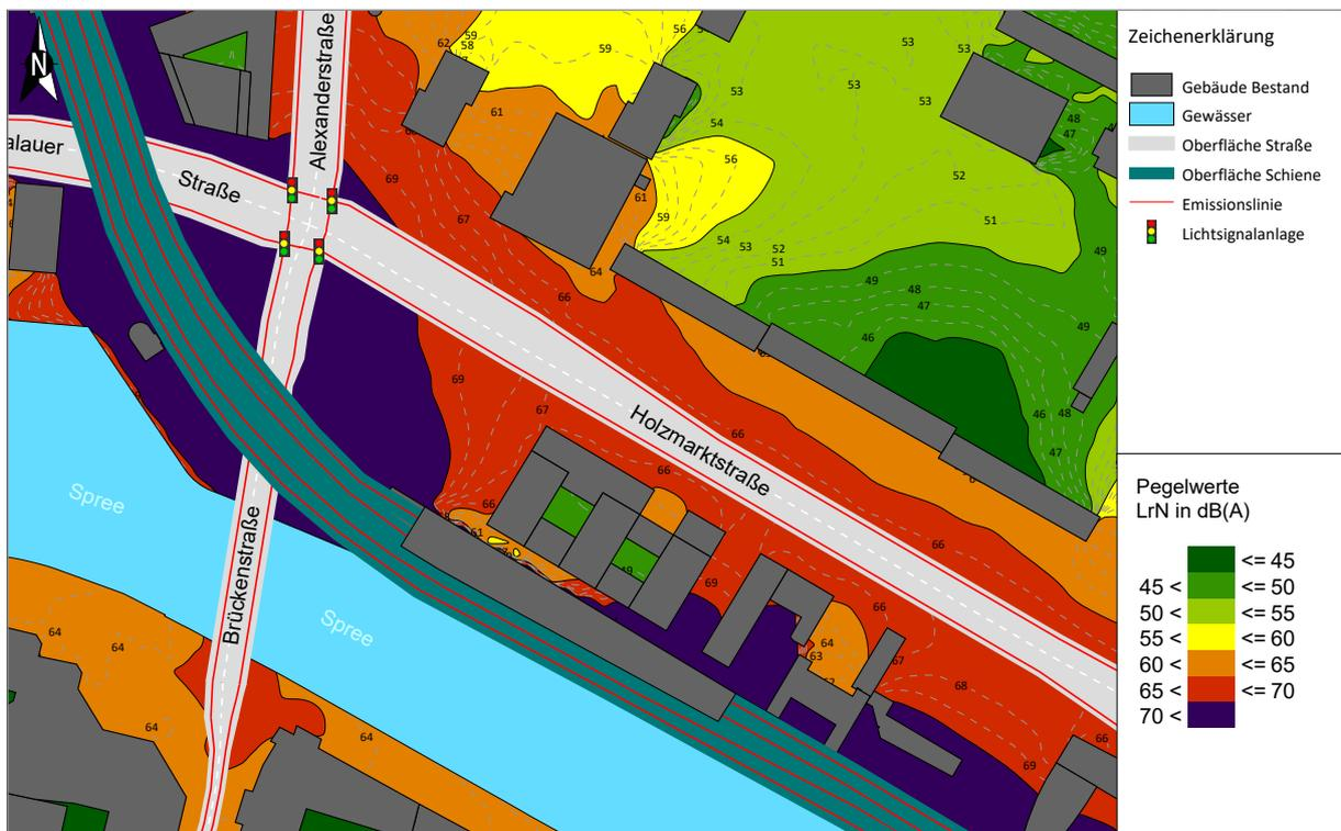
Anlage 3 Gebäudelärmkarte für das lauteste SW, Beurteilung nach DIN 18005, 06:00 - 22:00 Uhr - Nullfall
