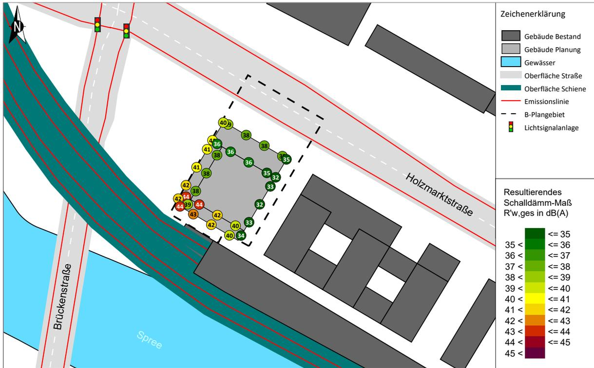
Abbildung 13 Gebäuelärmkarte für das lauteste SW, Beurteilung nach DIN 4109 (Büro), 06:00 - 22:00 Uhr
