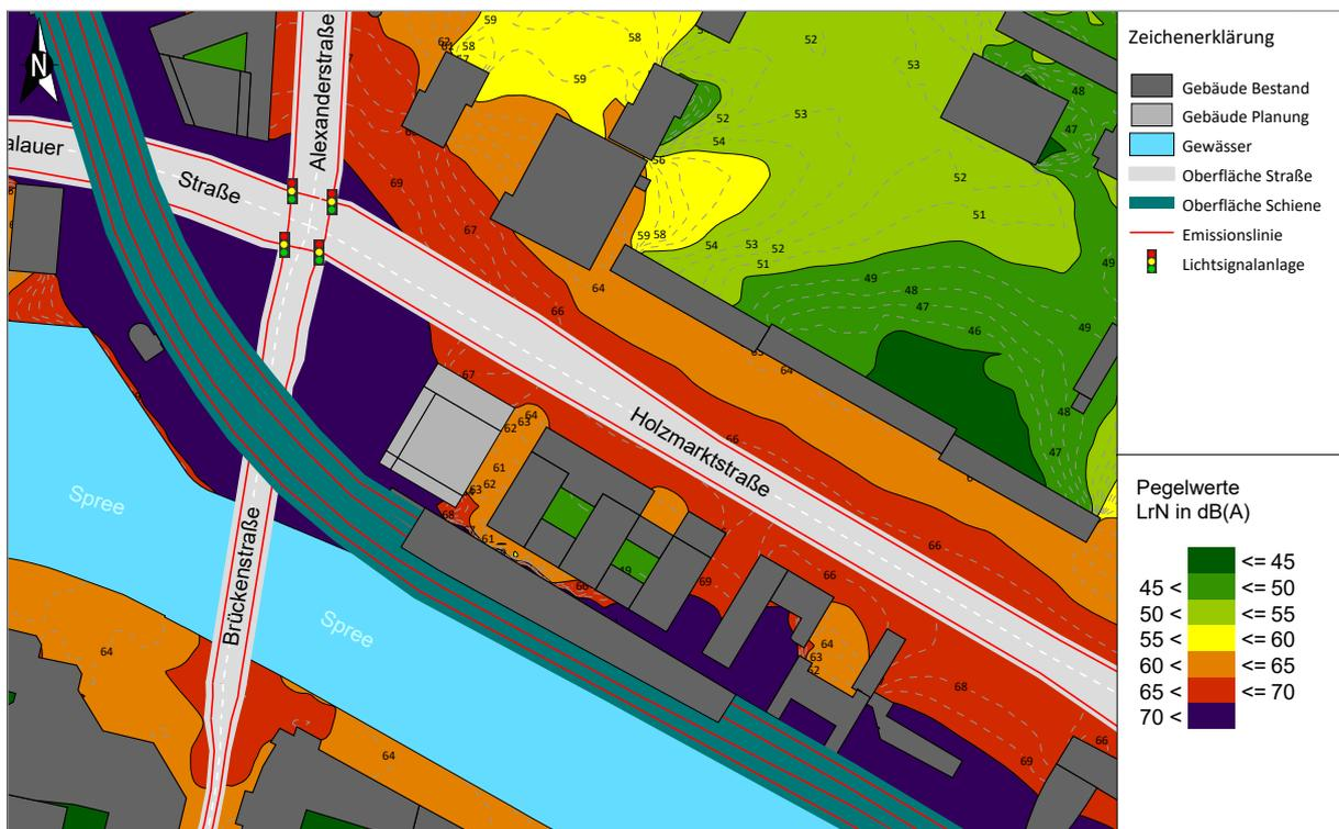
Abbildung 6 Isophonenkarte in 15 m Höhe über Gelände, Beurteilung nach DIN 18005, 22:00 - 06:00 Uhr
