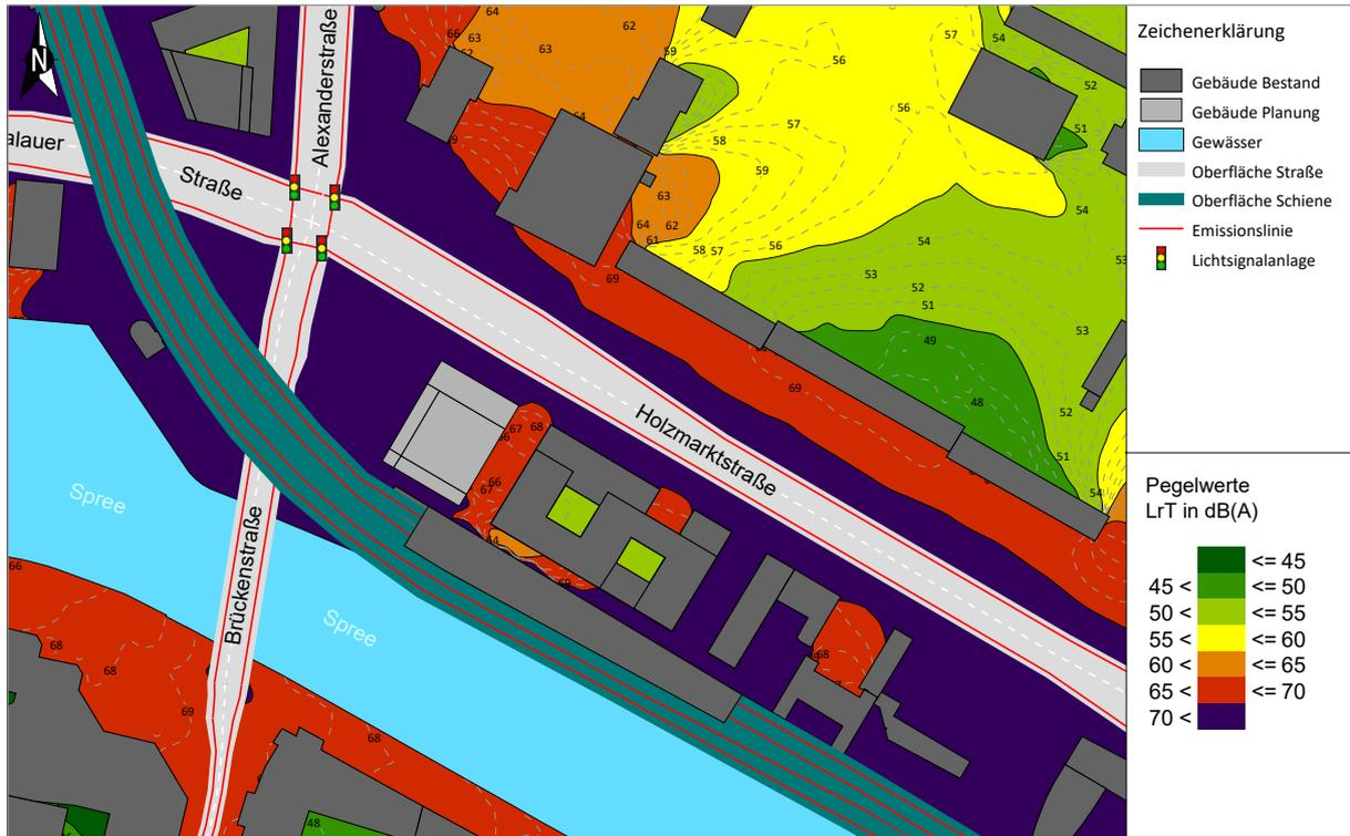
Abbildung 5 Isophonenkarte in 15 m Höhe über Gelände, Beurteilung nach DIN 18005, 06:00 - 22:00 Uhr
