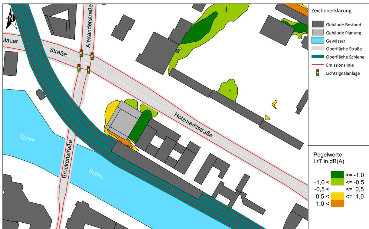
Abbildung 15 Isophonenkarte in 15 m Höhe über Gelände, Differenz Nullfall - Planfall, 06:00 - 22:00 Uhr
