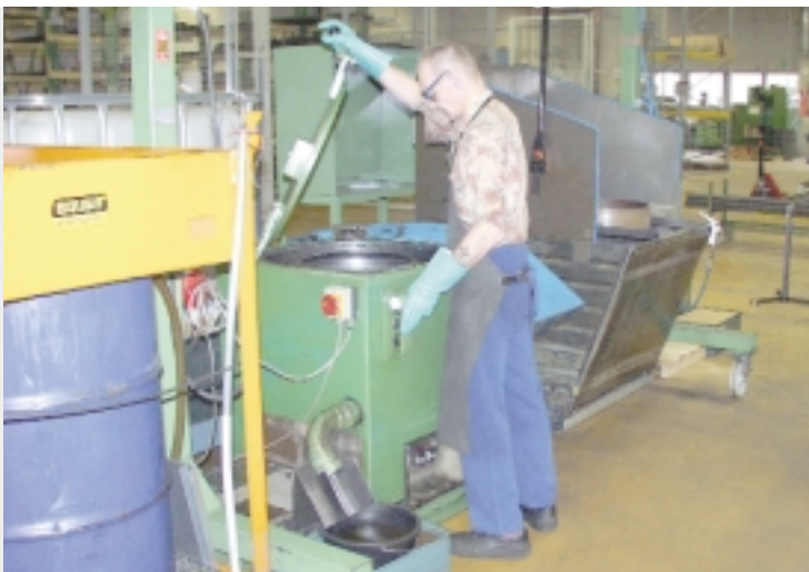
Anlagen zur Oberflächenreinigung sind ab einem Lösemittelverbrauch von einer Tonne pro Jahr anzeigepflichtig.
