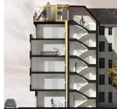
1:1 Projekt: Entwurf, Planung und bauliche Realisierung eines Solar-Plusenergiegedachaufsatzes (Fotovoltaikanlage mit 9,6 \text{ kW}_{\text{peak}} ) für den Gebäudebestand ( https://www.solar-rooftop.de )
